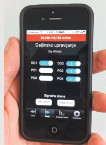
Mobilna aplikacija koju je razvio Atinel omogućava jednostavno upravljanje udaljenim postrojenjima
